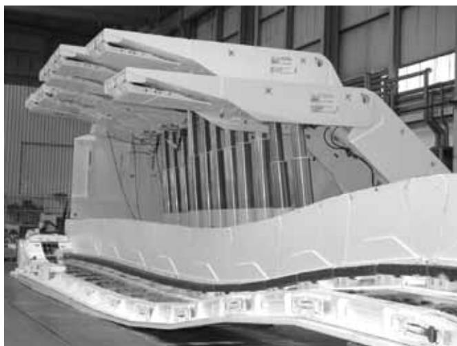
Приспособленность систем забойных конвейеров Caterpillar кизгибу в вертикальной плоскости
