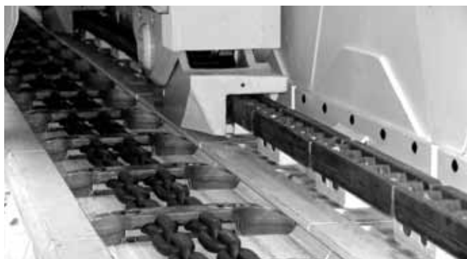
Jumbotrack® - система подачи выемочного комбайна
