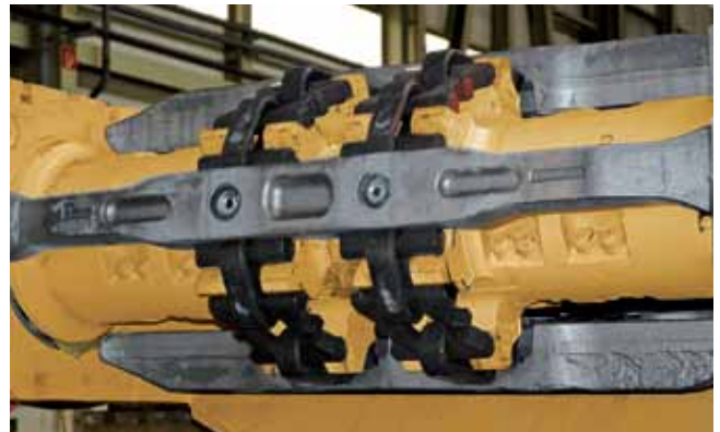
Приводная цепь и звездочка на консольном перегружателе Caterpillar
