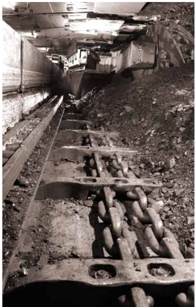
Комплексная выемка лавами Caterpillar с высокопроизводительной системой забойного конвейера
