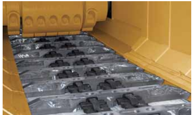
Приводная цепь внутри консольного перегружателя Caterpillar в зоне дробилки
