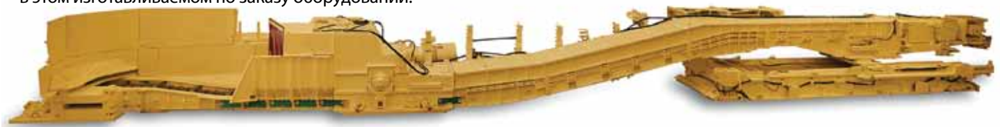
Полный штрековый конвейер Caterpillar или штрековый конвейерперегружатель (BSL), включающий дробилку и ленточную концевую часть
