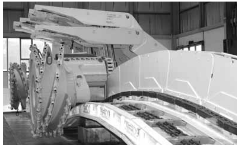
Моделирование бугра во время испытания на совместимость с выемочным комбайном
