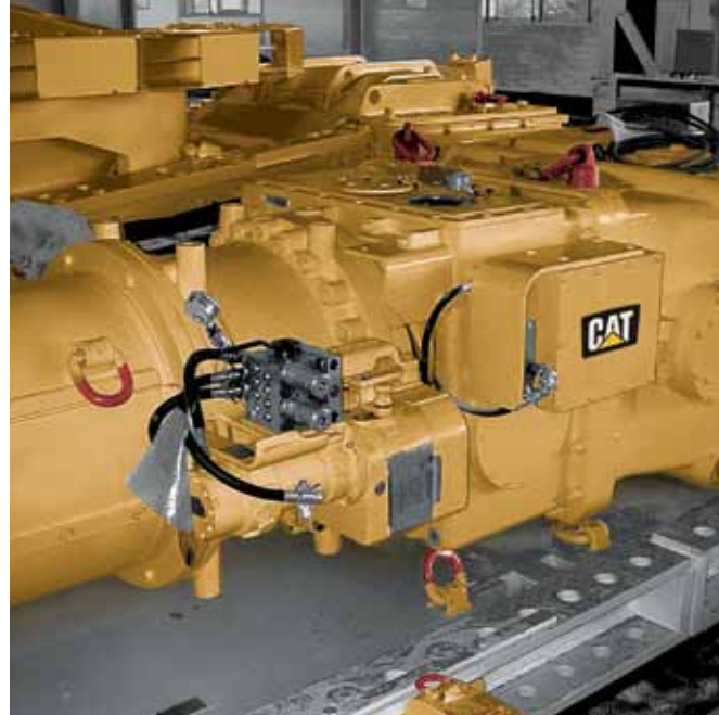
Интеллектуальная система приводов CST компании Caterpillar для высокопроизводительных забойных конвейеров
